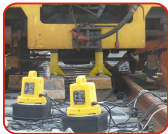
RSC-25噸 復軌實例應用 RSC-25 ton rail way application
